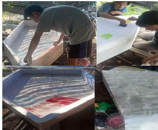
Gambar 5 Pelapisan Dasar Sebelum Di Resin
