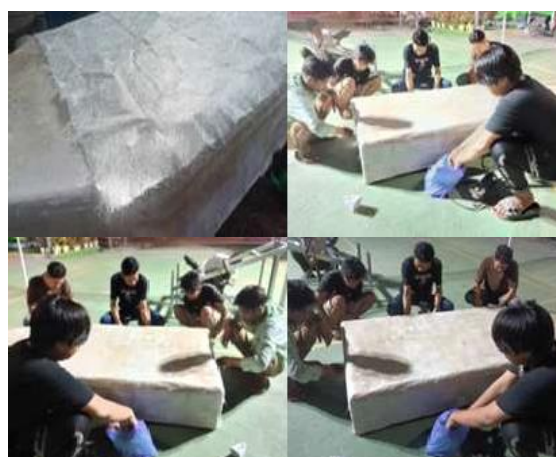
Gambar 6 Pelapisan Resin dan Serat Fiber
