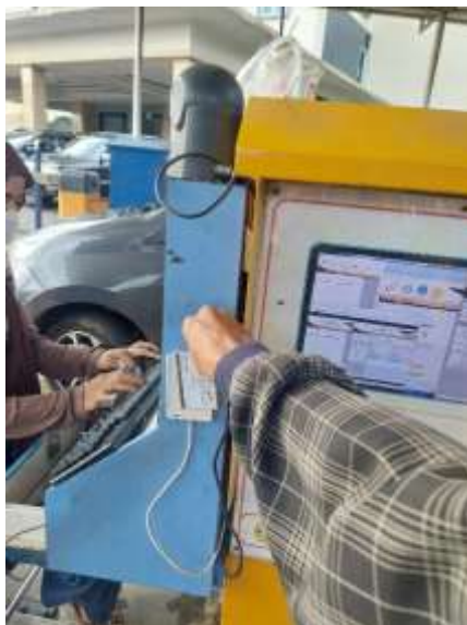
Gambar 1 Proses Tap In kendaraan pada sistem gate parkir otomatis berbasis RFID
